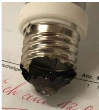
Рис. 1. Корродирование контактов цоколя E27
